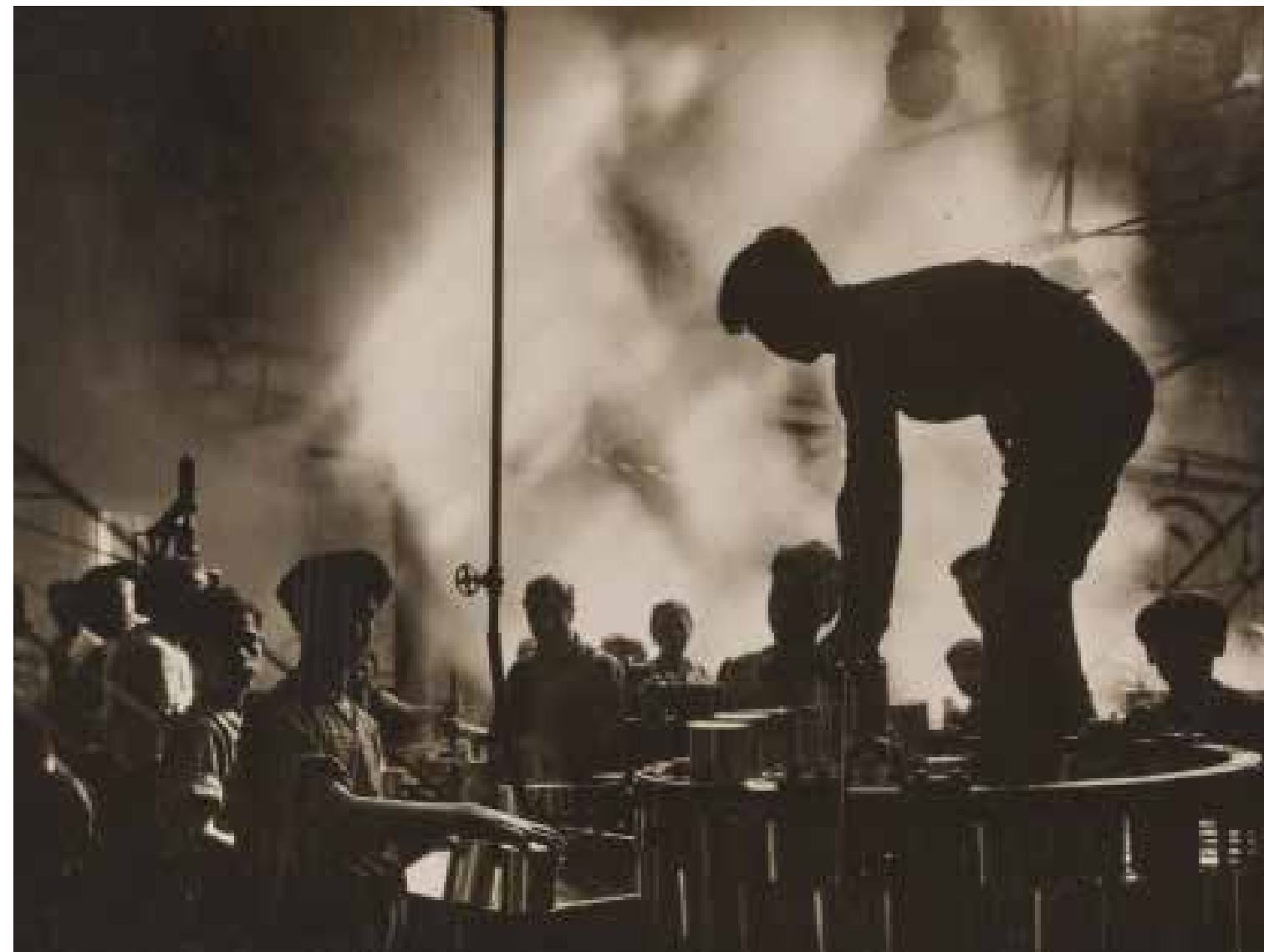
Sterilizzazione in autoclave delle scatole di conserva di pomodoro Autoclave sterilization of cans of tomato puree
